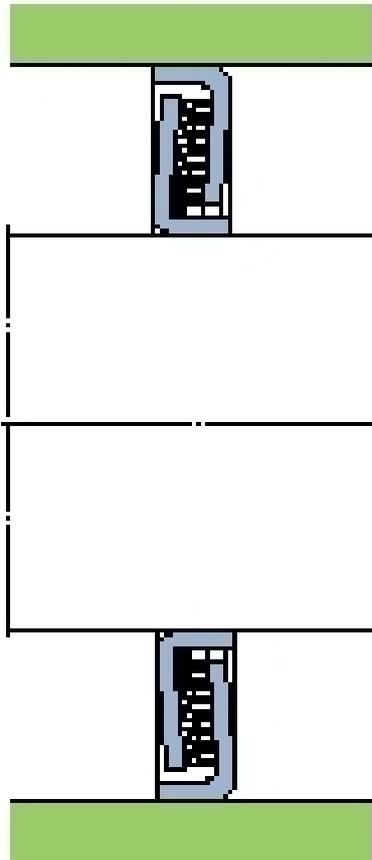
**Z 002 F - Dichtungslamellensatz beflackte Dichtscheibe
