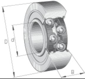
**3305-C3 - Schrägkugellager, Polyamidkäfig**
