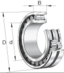
**NN 3024-AS-K-M-SP - Zylinderrollenlager zweireihig, Messingkäfig**
